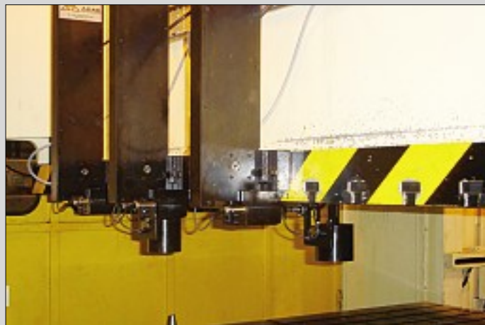
Programmerbara spännare för olika verktyg Programmable clamps for various dies Programmierbare Spanner für versch. Werkzeuge
